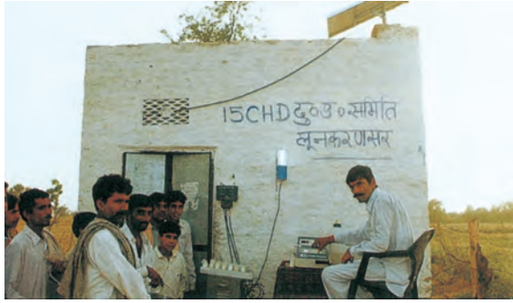
चित्र 5.10 – सौर ऊर्जा संचालित इलेक्ट्रॉनिक दुग्ध परीक्षण उपकरण
