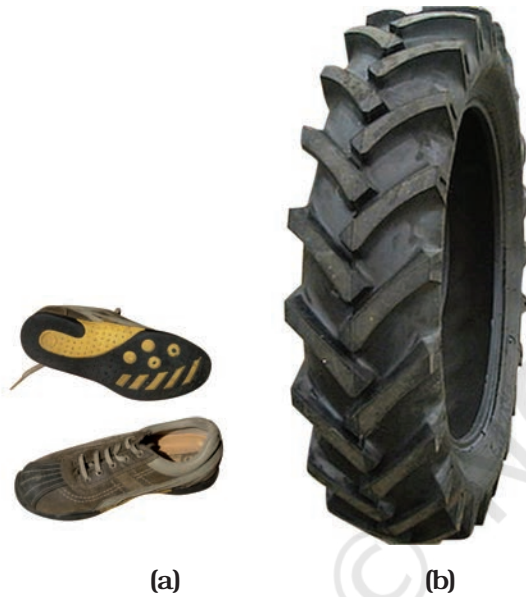
चित्र 9.11 : (a) जूते तथा (b) टायरों की तलियों को खाँचेदार बनाकर घर्षण अधिक किया जाता है।
