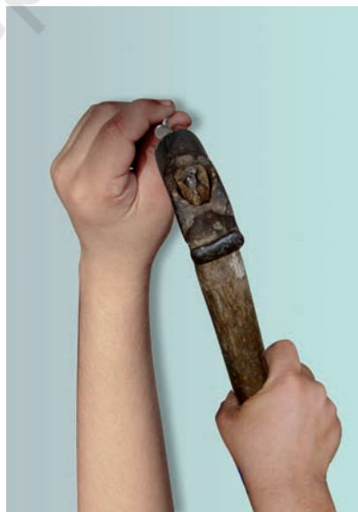
चित्र 9.7 : घर्षण के कारण दीवार में कील गड़ जाती है।
